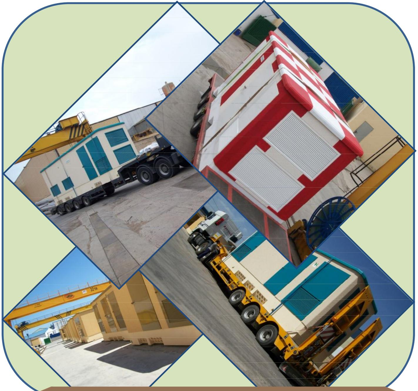
**EDIFICIOS PREFABRICADOS DE HORMIGÓN ARMADO PARA CENTROS DE TRANSFORMACIÓN DE TIPO SUPERFICIE**
