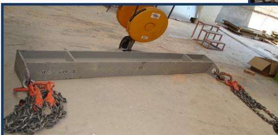
*Conjunto de izado compuesto por balancín más cuatro ramales de cadena con acortadores*
